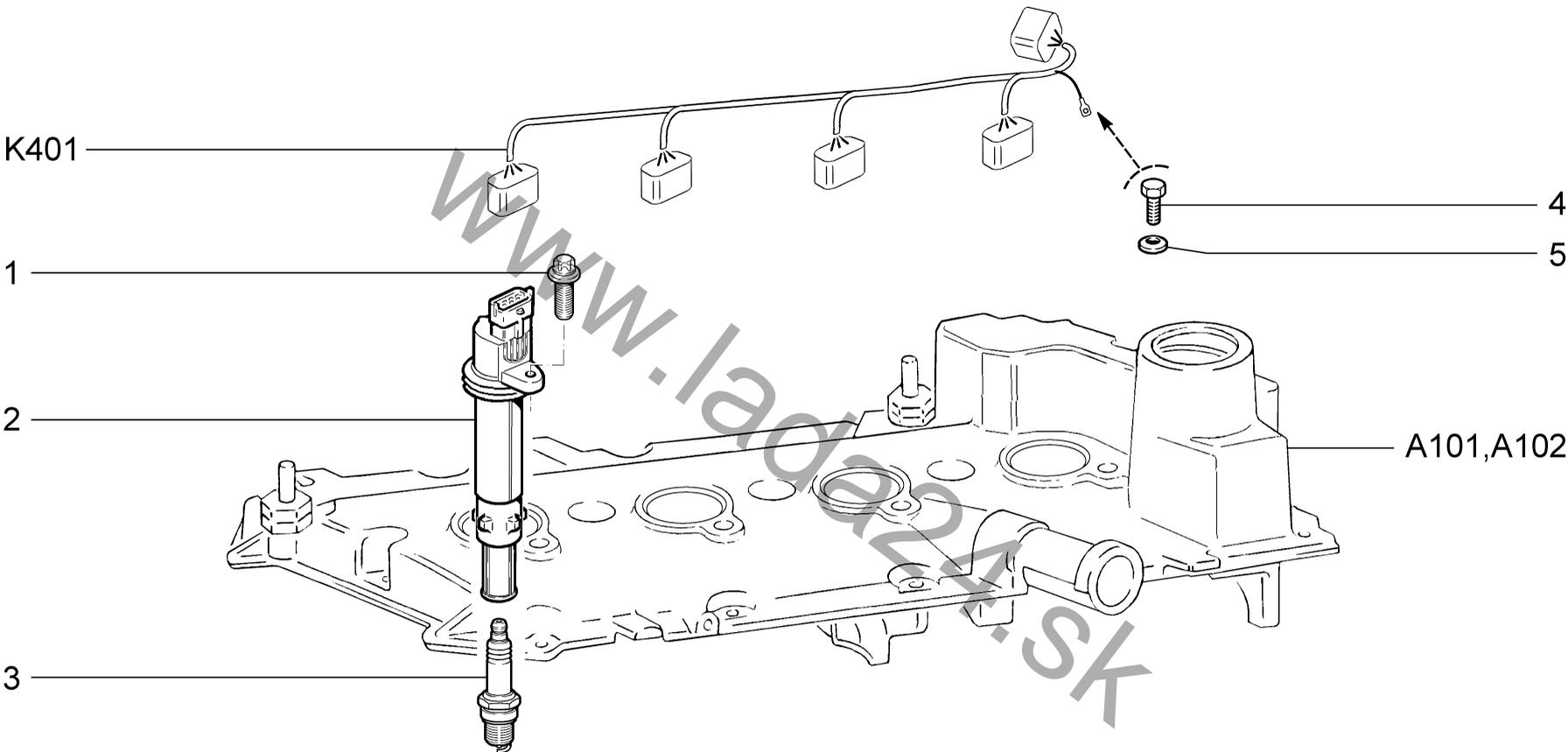
**МОДУЛИ И СВЕЧИ ЗАЖИГАНИЯ**
