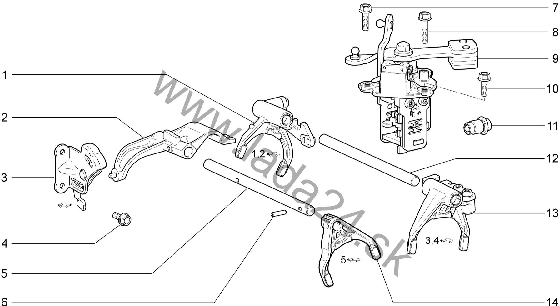
**МЕХАНИЗМ ПЕРЕКЛЮЧЕНИЯ ПЕРЕДАЧ (С10, С11)**
