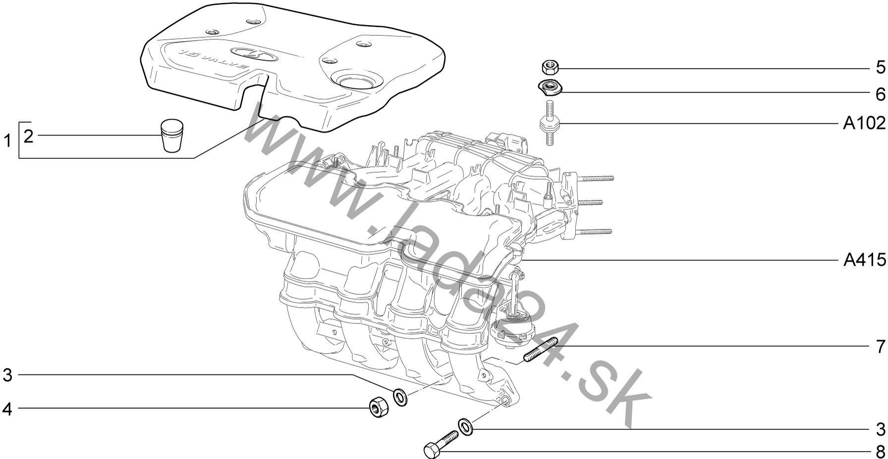
**УСТАНОВКА МОДУЛЯ ВПУСКА**
