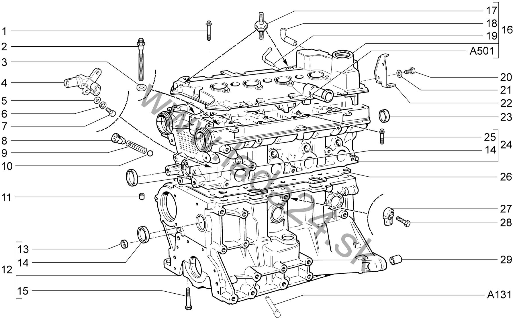
**БЛОК ЦИЛИНДРОВ И ГОЛОВКА БЛОКА**
