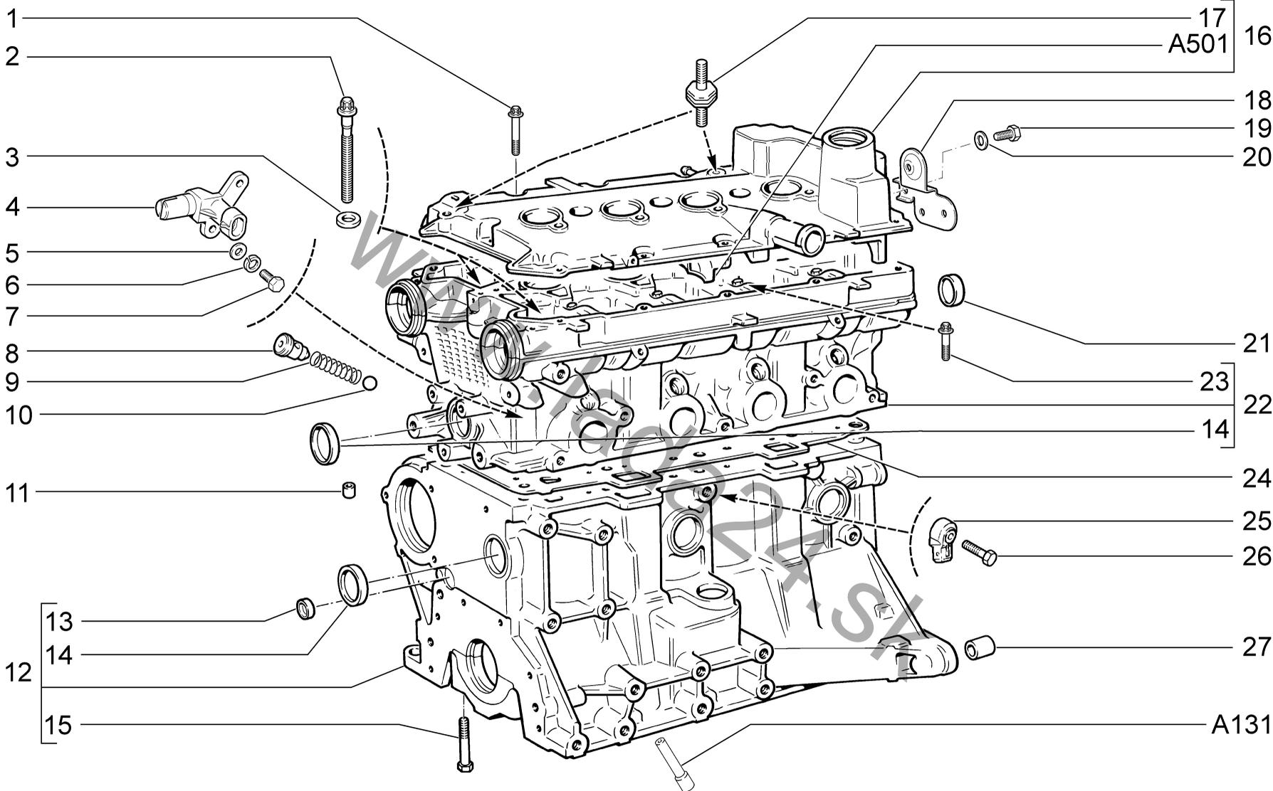
**БЛОК ЦИЛИНДРОВ И ГОЛОВКА БЛОКА**
