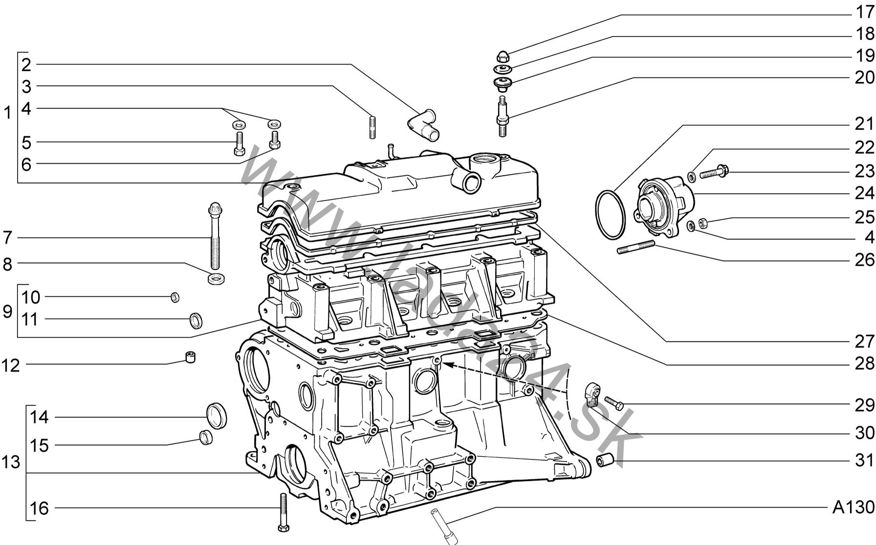
**БЛОК ЦИЛИНДРОВ И ГОЛОВКА БЛОКА**
